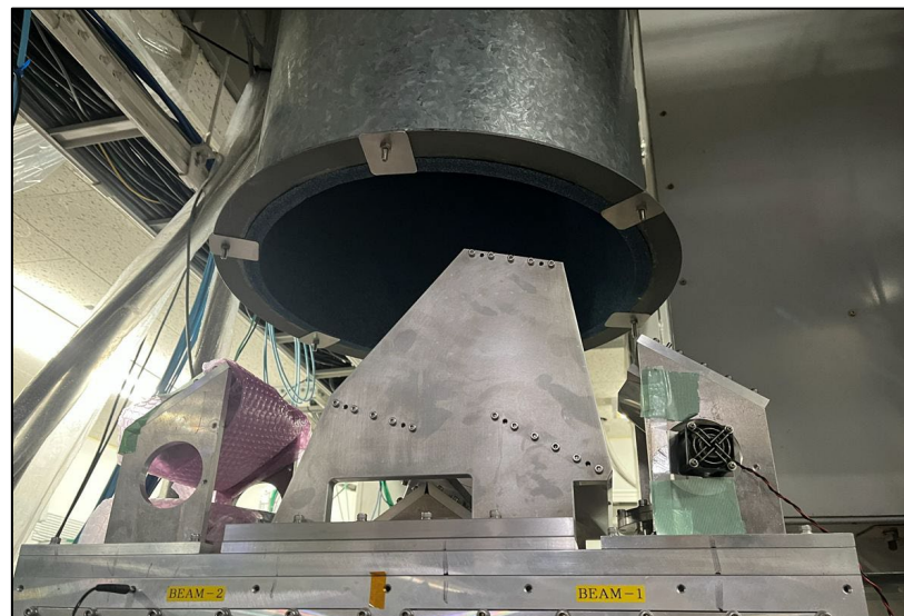
TZ受信機新搭載230 GHz帯光学系
